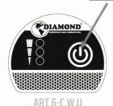
Das Display schaltet sich ein, wenn die Pumpe an die Stromversorgung angeschlossen ist. Unter Anwendung des "One-Touch" -Tasters können drei verschiedene Leistungskurven gewählt werden, wobei die ausgewählte Kennlinie über die LEDs angezeigt wird.
